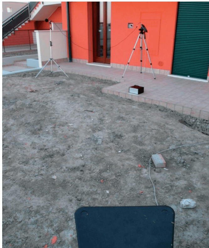
Fig. 2 – Misura di isolamento di facciata secondo la norma UNI EN ISO 16283-3.
